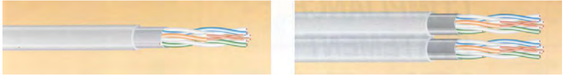
Kuva 4.5. Tavallinen neliparinen atk-kaapeli (yhteisellä suojanauhalla), "UC 300 S 24 4P", vieressä kaksinkertainen versio, huoneisiin kun usein vedetään kaksi tietoverkkoyhteyttä esimerkiksi tietokonetta ja puhelinta varten
