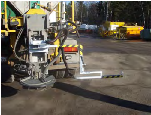
Kuva 20. Espoossa kehitelty kalsiumkloridin täsmälevitin. Tekijä Ari Molander, vanhempi hitsaaja, Espoon kaupunki.
