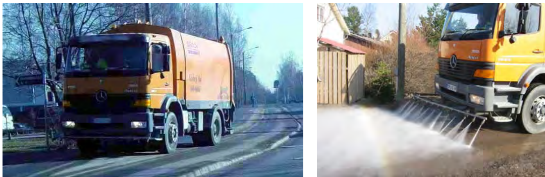
Kuva 48. Imulakaisu ja painepesu Suutarilan alueella 1.
