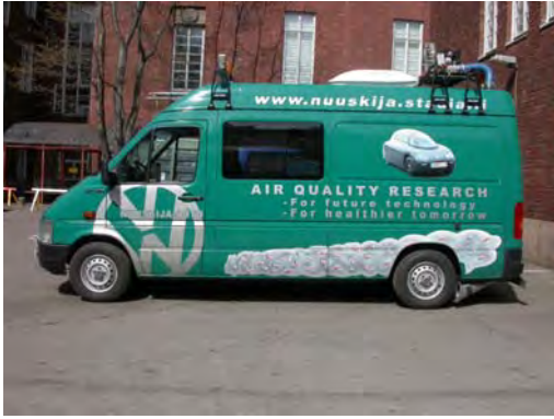
Kuva 1. Stadian Nuuskija-autolla voidaan tutkia kadun pinnasta nousevan hengitettävän pölyn määrää ajon aikana normaalissa liikenteessä. Siten saadaan tietoa kadun pinnalla olevan pölyn määrästä, joka mitataan vetävän takapyörän takaa.
