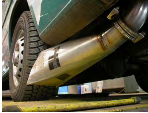
Kuva 1. Stadian Nuuskija-autolla voidaan tutkia kadun pinnasta nousevan hengitettävän pölyn määrää ajon aikana normaalissa liikenteessä. Siten saadaan tietoa kadun pinnalla olevan pölyn määrästä, joka mitataan vetävän takapyörän takaa.
