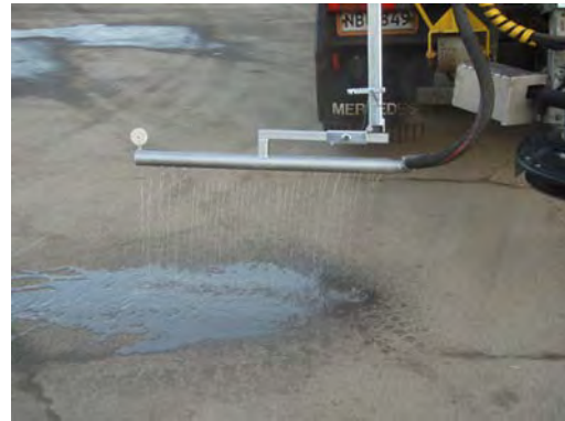
Kuva 20. Espoossa kehitelty kalsiumkloridin täsmälevitin. Tekijä Ari Molander, vanhempi hitsaaja, Espoon kaupunki.
