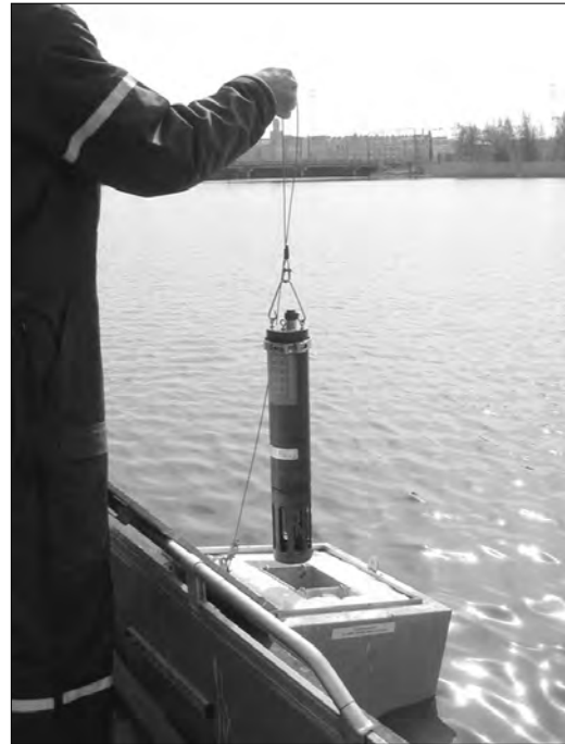
Kuva 2. Jatkuvatoiminen näytteenotin, sondi, nostettuna suojalaatikostaan Töölönlahden havaintopaikalla 179.
