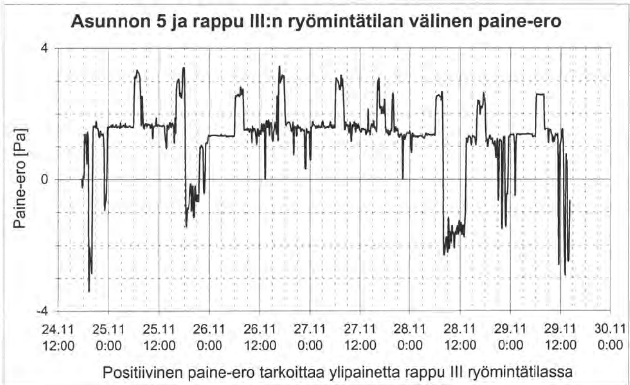
Kuva 19. Asunnon 5 ja rakennuksen B ryömintätilan välinen paine-ero.
