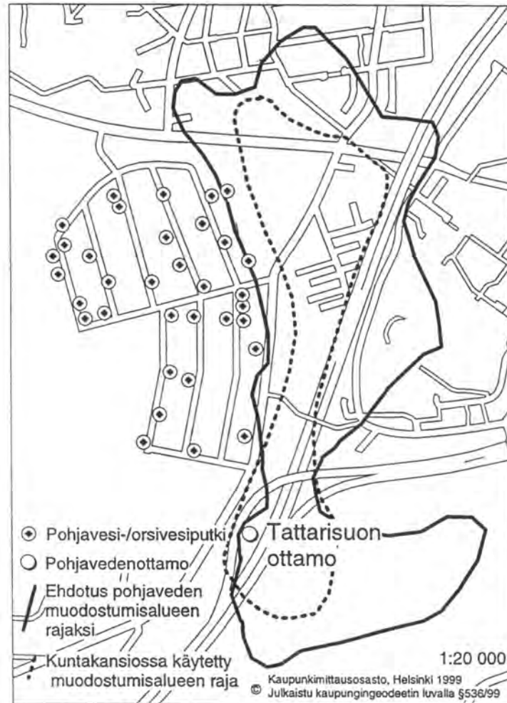
Kuva 5.2. Tattariharjun pohjavesialue. Helsingin pohjavesialueiden kuntakansiossa (Uudenmaan ympäristökeskus 1996) käytetty pohjaveden muodostumisalueen rajaus sekä uudempi ehdotus muodostumisalueen rajaksi (Svanström ja Raudasmaa 1998). Kartalla on esitetty myös pohjavesi- ja orsivesiputkien sijainnit.
