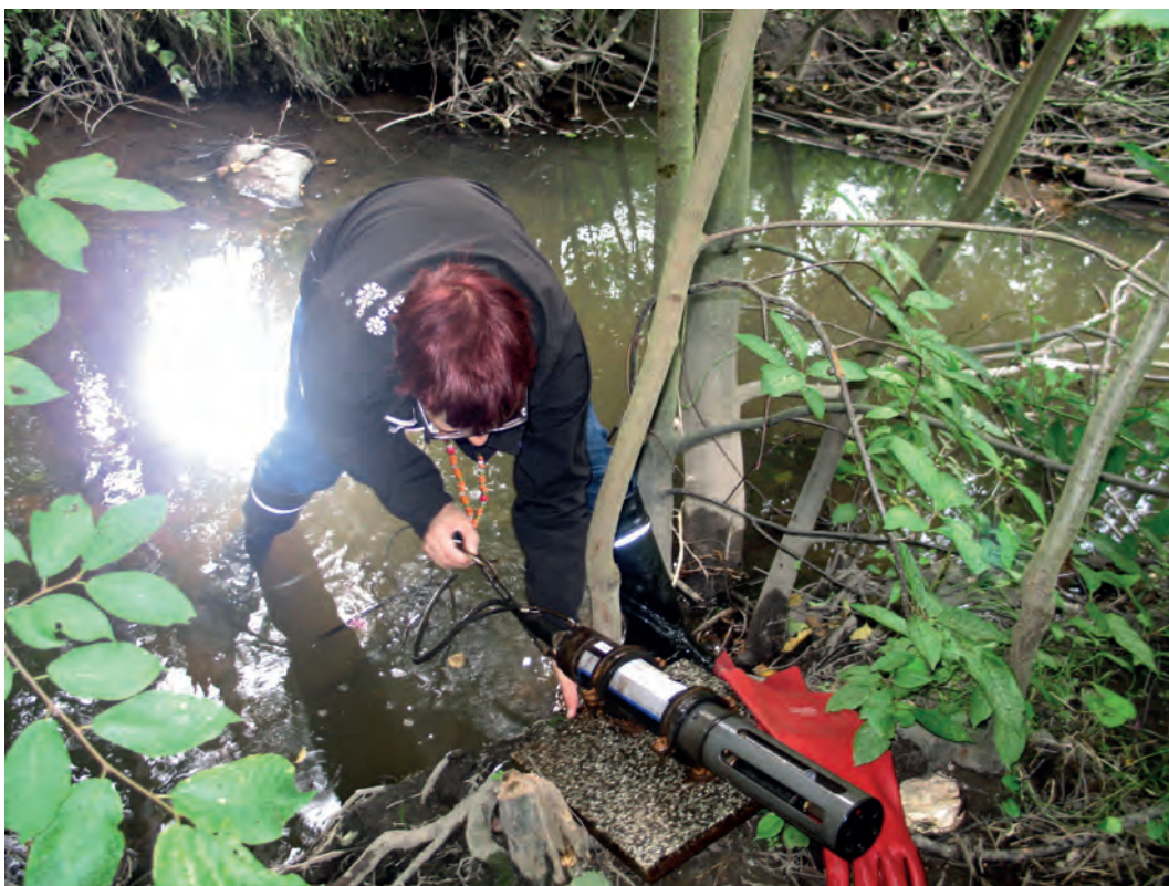
Kuva 40. YSI 6920 -sondi kiinnitettynä betonialustaan ja nostettuna uomasta huoltoon varten.
