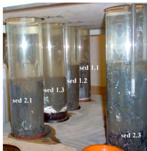
Kuva 8. Laajalahden koeysiköiden sedimentin laatu läpivirtauskokeen alussa. MLJ = orgaaninen lieju, SLF = sulfidiraitoja, SLFLJ = sulfidilieju. Oikealla valokuva näytepisteiden 1 ja 2 koeysiköistä (2.1 ja 2.3) kokeen alussa.
