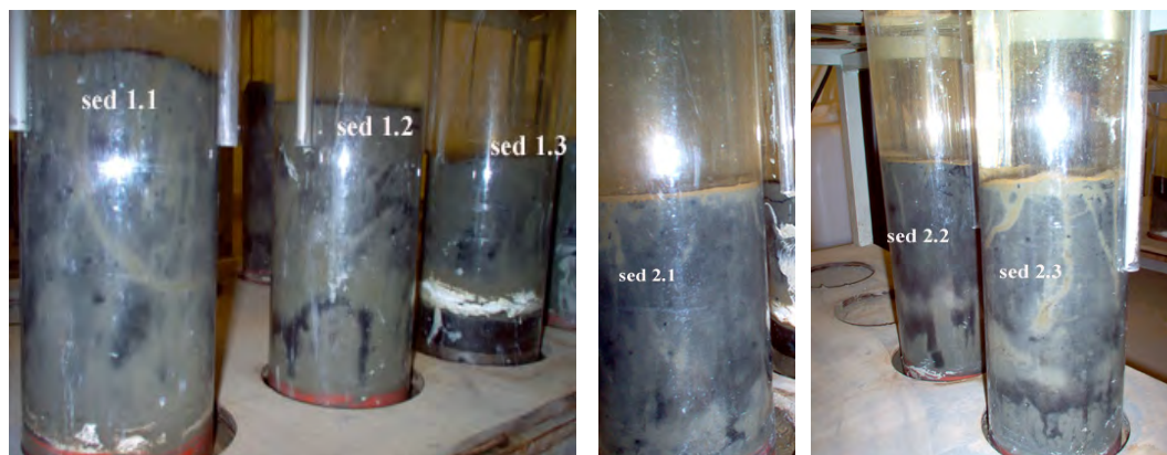
Kuva 9. Laajalahden näytepisteiden 1 ja 2 koeyksiköt läpivirtauskokeen lopussa. Koeyksiköiden 1.1 ja 2.3 pinnalla on selvästi havaittavissa pohjaeläinten tekemiä käytäviä. Lisäksi jokaisessa koeyksikössä on havaittavissa mustia sulfidiraitoja. Koeyksiköissä 1.1 ja 1.3 on pohjalla sedimenttipatsasta kohottava styrox-levy.
