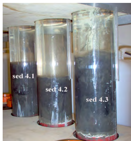
Kuva 10. Koeyksiköiden sedimentin laatu läpivirtauskokeen alussa. MLJ = orgaaninen lieju, SLF = sulfidiraitoja, SLFLJ = sulfidilieju. Oikealla valokuva Seurasaarenselän näytepisteiden 4 koeyksiköistä kokeen alussa.
