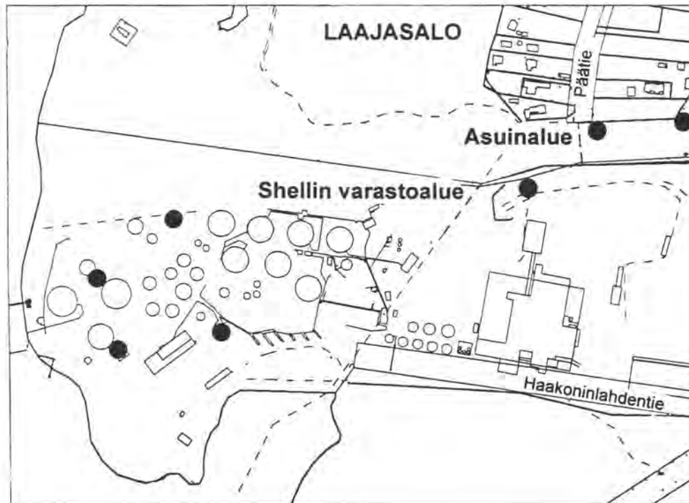
Kuva 8. Mittauspisteet Laajasalon öljyvarastoalueella.
