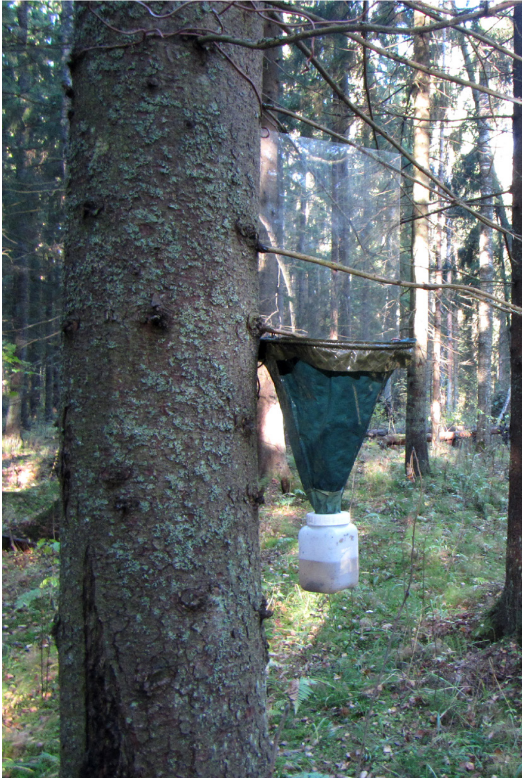
Kuva 10. Runkoikkunapyydydys. Kun lentävä kovakuoriainen törmää pleksilevyyn, se putoaa suppilon kautta keräyssäiliöön. Keräyssäiliössä käytettiin kyllästetyn suolaveden ja pesuaineen sekoitusta. Pesuaine rikkoo nesteen pintajännityksen, jolloin kuoriainen hukkoo eikä pääse kiipeämään pois astiasta. Suola säilöo näytteet niin, etteivät ne pilaannu tyhjennysten välillä. Kuva: Elina Manninen.
