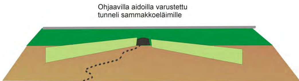
Kuva 15. Matalilla esteillä voidaan ohjata esimerkiksi sammakot tai siili käyttämään tien ali kulkevaa putkea.
