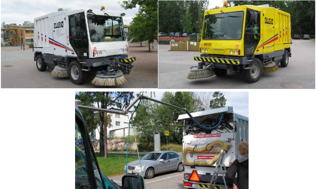
Kuva 43. Tutkitut laitteet ja poistoilman hiukkaspitoisuuden mittaussjärjestely.
