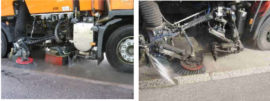
Kuva 33. Vantaan kaupungin (vasen kuva) ja Lakaisutekniikan (oikea kuva) pesevällä imusuulakkeella varustettujen imulakaisulaitteistojen toiminta. Lakaisutekniikan laitteessa on lisäosana pesutanko kanttikivien läheisyydessä olevan aineksen puhdistamiseen.
