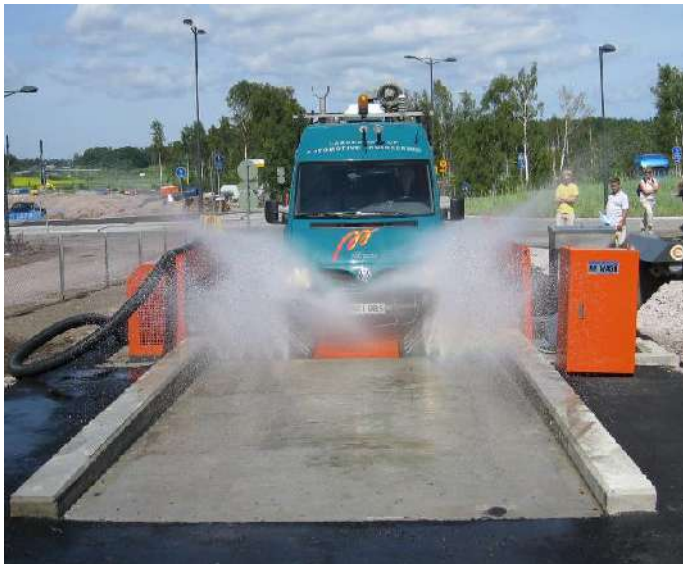
Kuva 62. Renkaanpesulaite Espoon Suurpelossa.
