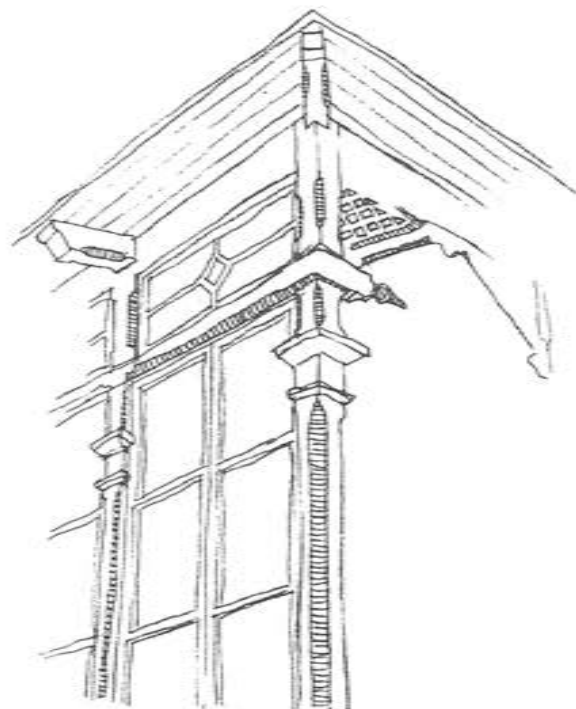
Uusrenesanssin puutalojen listoitut oli moniväristä. Syvennykset ja leikkaukset olivat usein eri väreissä kuin itse lista tai rakennosa, onpa julkisivuissa käytetty shabloona-koristemaalauksiakin.
