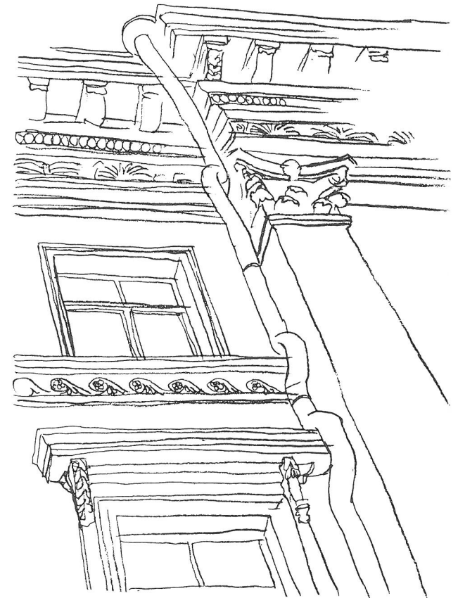
Empiren aikana rännit maalattiin useimmiten mustaksi ruskealla taittaen. Joskus rännit on kuitenkin ilmeisesti maalattu julkisivun väriin.
