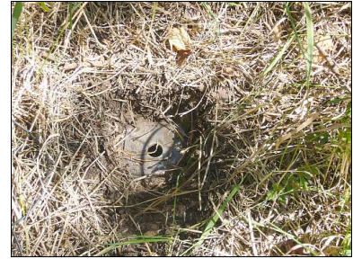
Kuvat B70-B72. Mittauspiste q13. Radanvarsi, huomaa anturin kiinnitys maaruvoilla.
