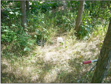
Kuvat B70-B72. Mittauspiste q13. Radanvarsi, huomaa anturin kiinnitys maaruvoilla.
