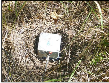
Kuvat B70-B72. Mittauspiste q13. Radanvarsi, huomaa anturin kiinnitys maaruvoilla.
