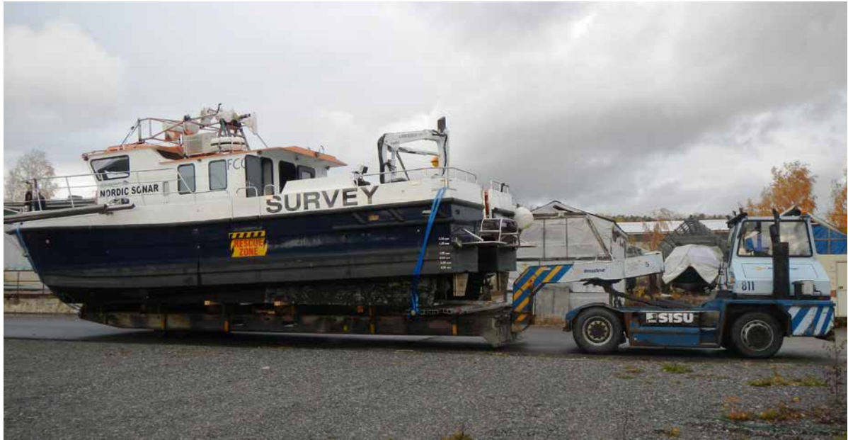
Kuva 27. Aluksen siirto suljetulla satama-alueella erikoiskalustoa hyödyntäen (P. Rihti 2015)
