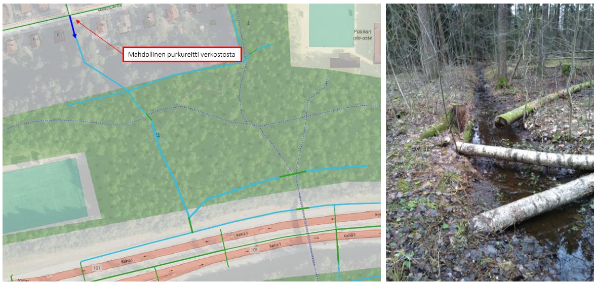
Kuva 30. LPP-6. DN 800 verkoston ylivuoto tulvatilanteessa Halkosuontieltä Kehä I varteen Pakilapuiston korpeen. Huomioitava uhanalaiset luontotyypit.
