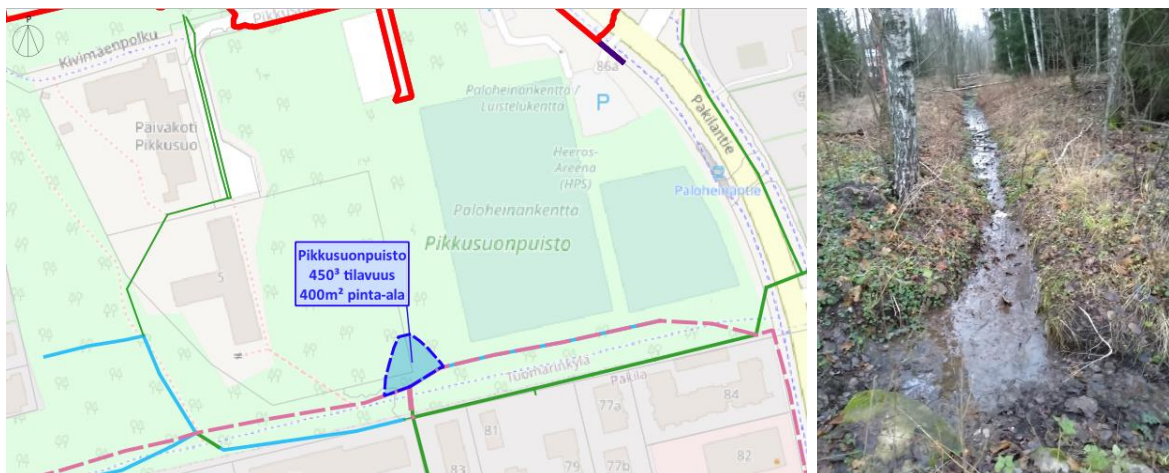
Kuva 28. LPP-2-1. Viivytyksellä Pikkusuonpuistossa Paloheinänkentän etelälaidalla (ojien risteyskohdan laajentaminen).
