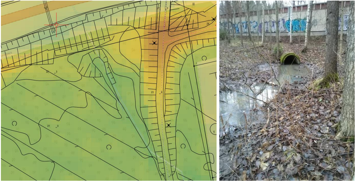
Kuva 35. LPE-6. Kehä I:n alituksen alajuoksun puolella on allasmainen oja, johon Länsi-Pakilan valuma-alueen pohjoisosien VE-B:n kanssa tarvitaan pato/viivytysallas. Jatkosuunnittelussa huomioitava taimen.
