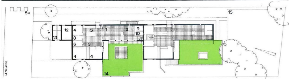
Kuva 120-122. Lepolantien varteen (nro 90) 1970 valmistunut, Arkkitehtitoimisto Reino Huhtiniemen suunnittelema paritalo on edustava esimerkki aikakauden pientaloarkkitehtuurista. Tiiliverhoiltu, valkeaksi slammattu pulpettikattainen rakennus on ulospäin muurimaisesti sulkeutuva, ja kadun suuntaan näkyy lähinnä autokatos. Myös asuntopihoja rajaavat valkeat tiilimuurit. Puutarhan on suunnitellut maisema-arkkitehti Maj-Lis Rosenbröijer. Kohde on esitelty Arkkitehtilehden numerossa 7/1970. Kuvat Reino Huhtiniemi ja Jouko Levanto (ARK 7/1970).
