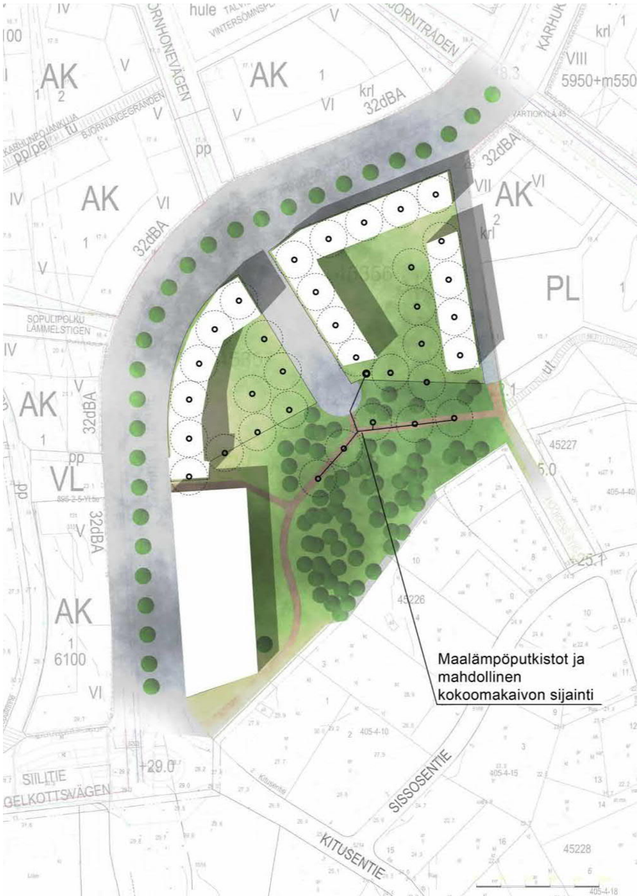
Kuva 16. Maalämpöjärjestelmän osien sijoittaminen viheralueelle.
