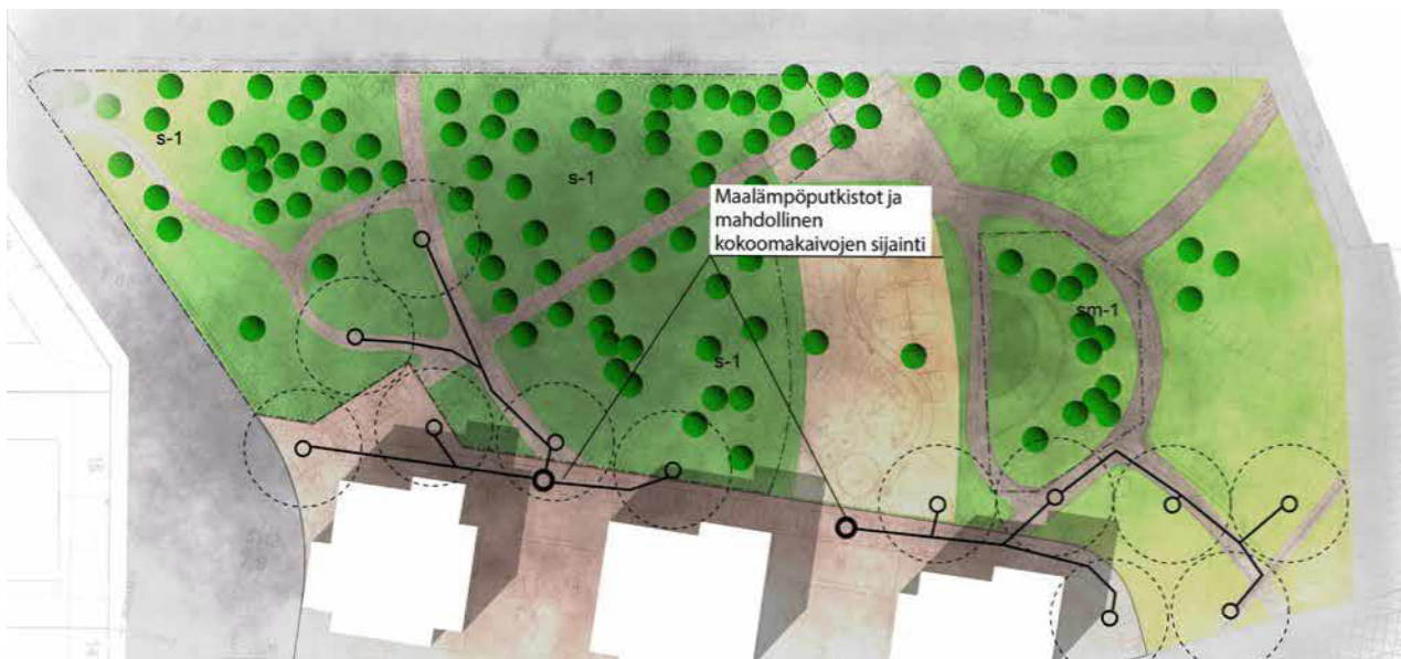
Kuva 22. Maalämpöjärjestelmän osien sijoittuminen rakennettuun puistoon.
