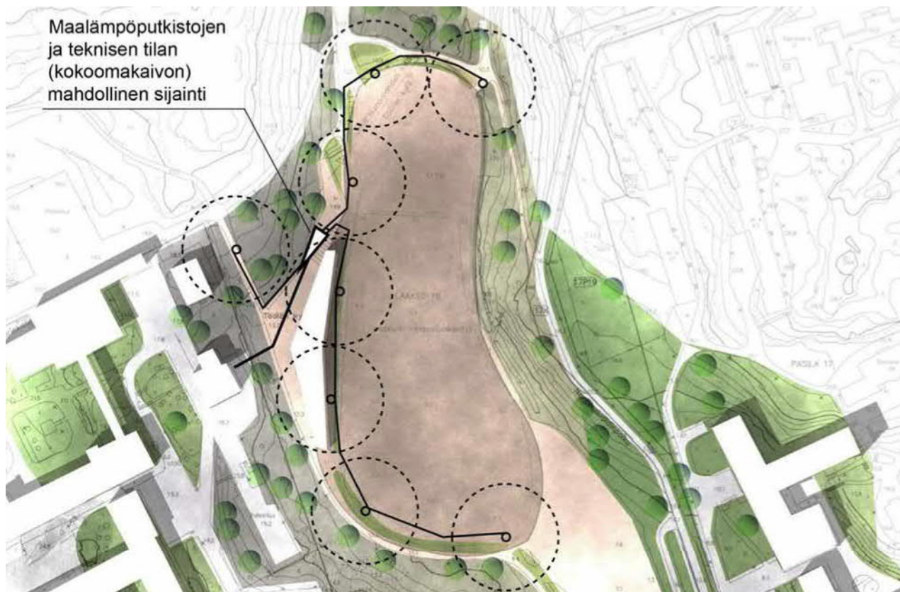
Kuva 26. Energiakaivojärjestelmän osien sijoittamislunnos
