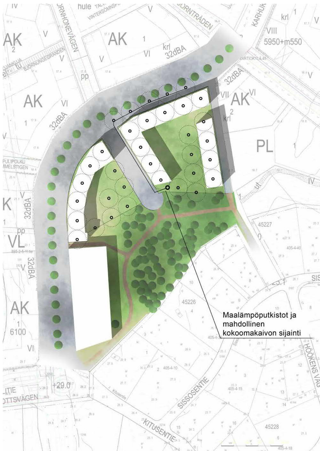
Kuva 19. Maalämpöjärjestelmän osien sijoittaminen katualueelle
