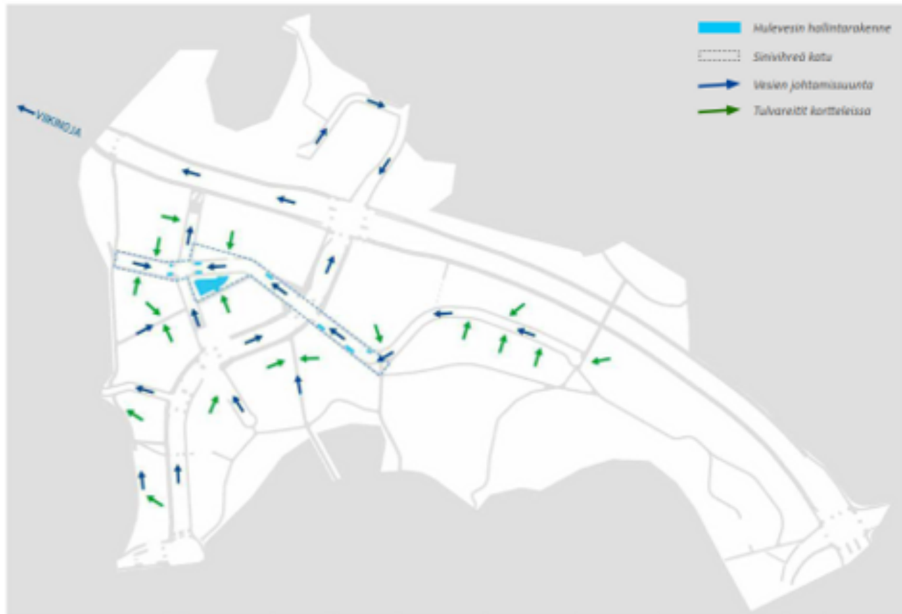
Kuva 26. Hulevesien käsittelyä ja johtamista koskeista päätöksistä.
