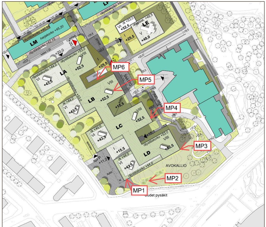
Kuva 5.1. Mittauspisteiden sijainnit kalliion asennettuna. Kaikissa mittauspisteissä mitattiin värähtelyä kolmeen suuntaan. Kohteen lähin julkisivun on noin 24 metrin etäisyydellä lähimmän raiteen keskilinjasta.
