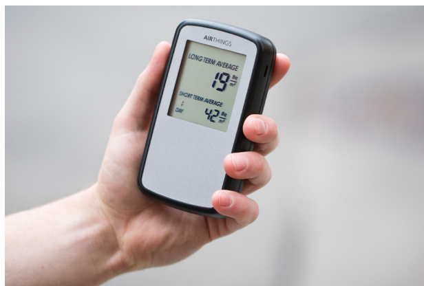
Kuva 12: Käsikäyttöinen radonmittari, Airthings
