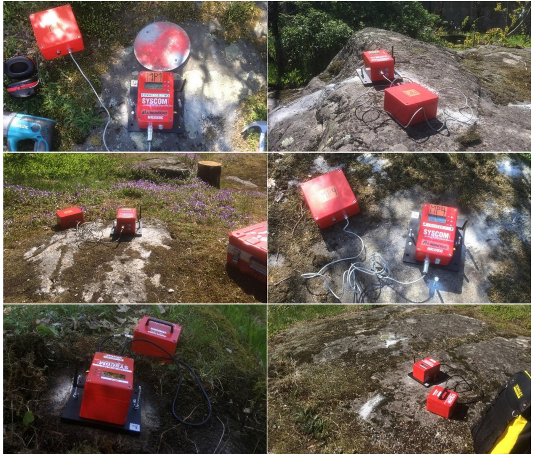
Kuva 5.2. Mittareiden asennus kiila-ankkureilla kallioon (MP1-6 vasemmalta ylhäältä alkaen).
