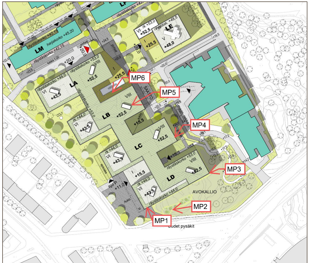
Kuva 5.1. Mittauspisteiden sijainnit kallioon asennettuna. Kaikissa mittauspisteissä mitattiin värähtelyä kolmeen suuntaan. Kohteen lähin julkisivun on noin 24 metrin etäisyydellä lähimmän raiteen keskilinjasta.
