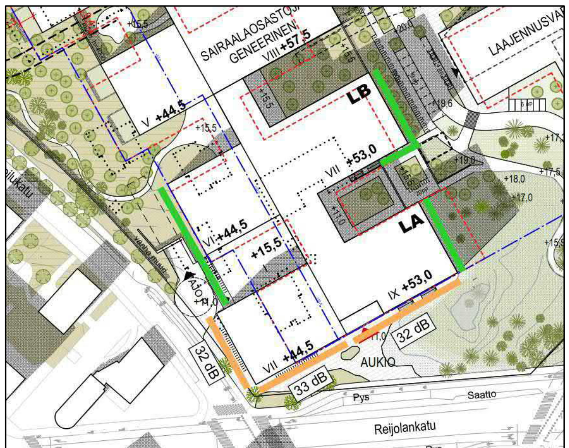
Kuva 2. Julkisivuille muodostuvat äänitasoerovaatimukset rakennuksissa LA ja LB. Oranssilla merkityt julkisivut \Delta L_{A,vaad} = 33...32 dB. Vihreällä merkityt julkisivut \Delta L_{A,vaad} = 30 dB.
