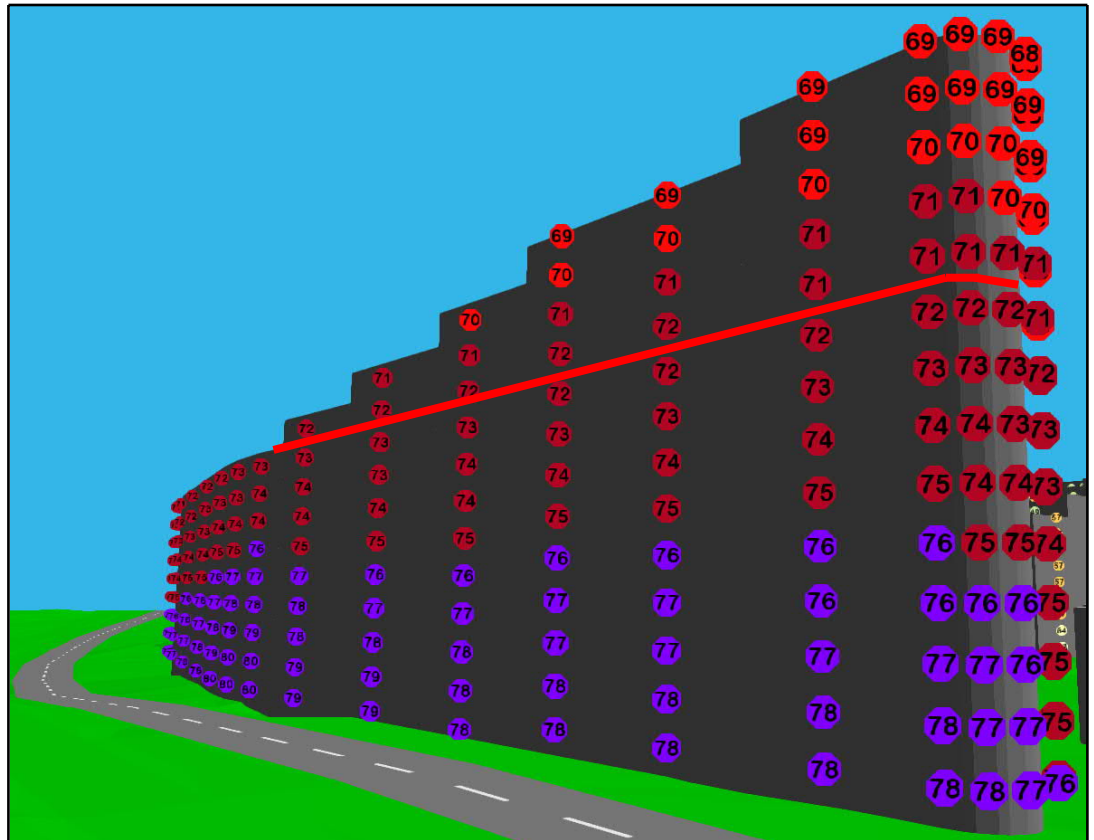
Kuva 8. Raskaan liikenteen enimmäisäänitasot pohjoisjulkisivulla. Alin asuinkerros (9. krs) sijaitsee viitesuunnitelman mukaan punaisen viivan yläpuolelta.
