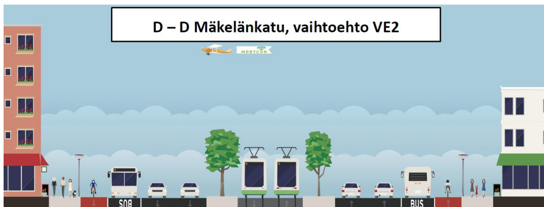
Kuva 5. Mäkelänkadun poikkileikkaus Sturenkadun pohjoispuolelta vaihtoehdossa 2.
