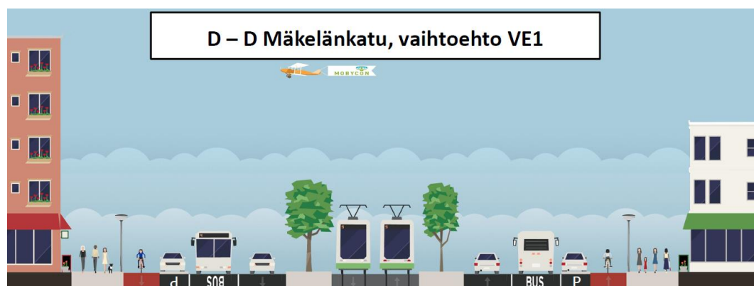
Kuva 4. Mäkelänskadun poikkileikkaus Sturenkadun pohjoispuolelta vaihtoehdossa 1.
