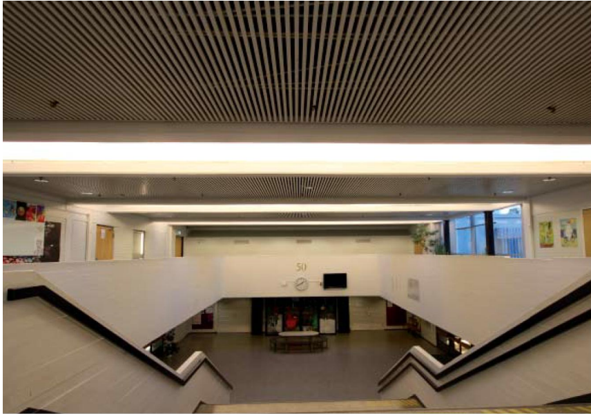
Sisäätulohalli kohden liikuntasalia. Alkujaan avoin yhteys liikuntasaliin tukittiin vuoden 2003 peruskorjauksen yhteydessä. IV-kanavatila peitti 2. kerroksen lasiseinän ja 1. kerroksen paljeovet vaihdettiin umpiseinään ja parioviin. Alakton valaisimet myös uusittu. Alkujaan valaisimet oli sijoitettu säleiden taakse, nyt katossa on upotetu pyöreät downlight-valaisimet. Oikeanpuolimmainen kuva ylhäällä julkaistu Arkkitehilehdessä 12/1967. SRMA.
