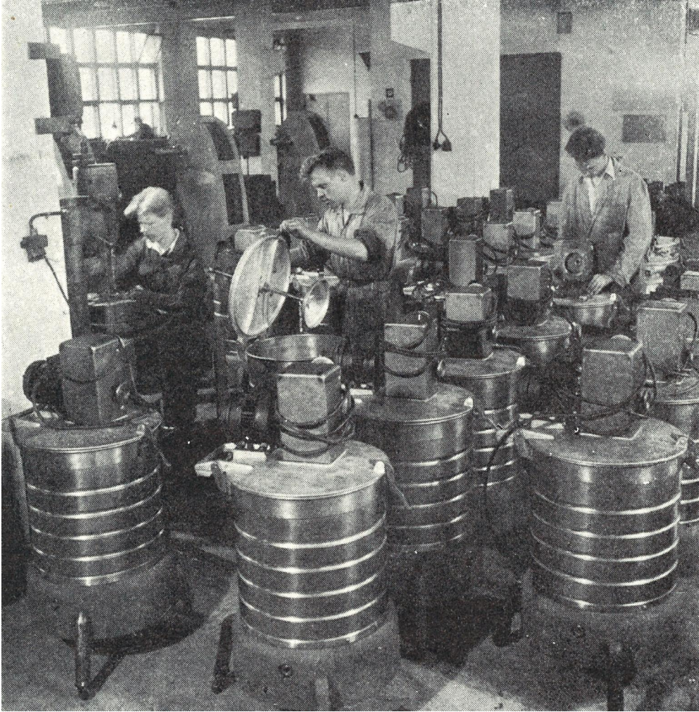
"Auri-pesukoneiden kokoonpano Herttoniemen tehtaalla". Kuva on noin vuodelta 1950 ja se on julkaistu Bernhard Wuolteen historiikissa vuodelta 1951, 159. Rakennuksen sisäpinnat ovat vaaleaksi rapattuja ja suurista ikkunoista on tullut runsaasti valoa tehdastilaan.
