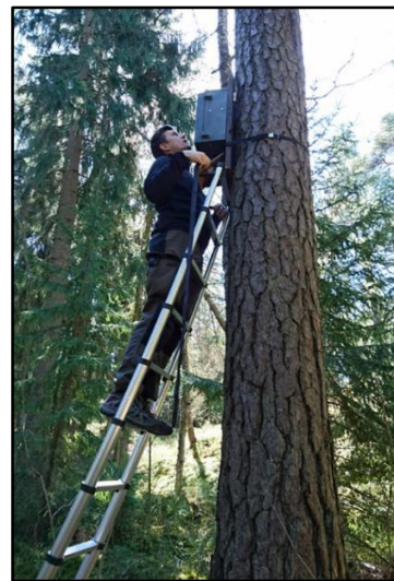
Kuvat 1 ja 2. Pitkäaikaiset passiiviseurantadetektorit olivat säänkestävissä koteloidissa. Ne asennettiin noin 3 metrin korkeudelle puihin
