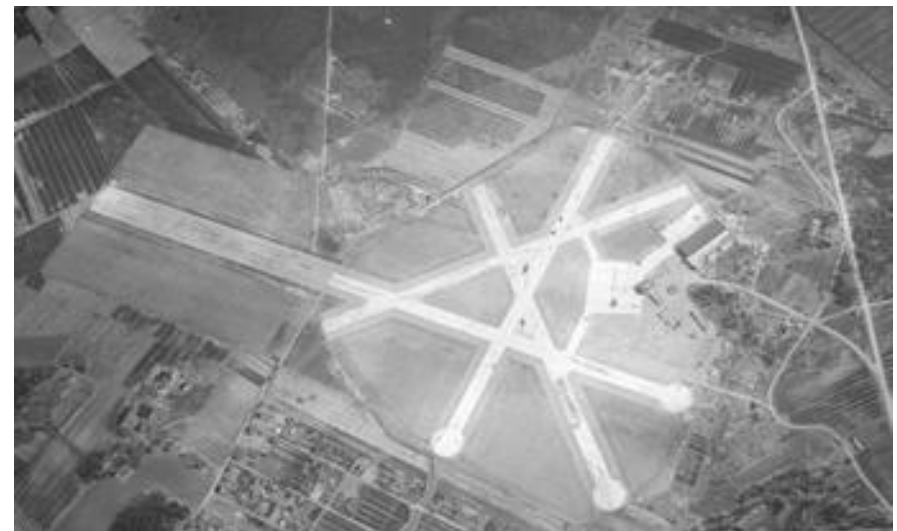
Kiitoteiden pidennykset näkyvät vuonna 1943 otetussa valokuvassa. Itäinen kiitotien laajennus vasta työn alla. (SIL)
