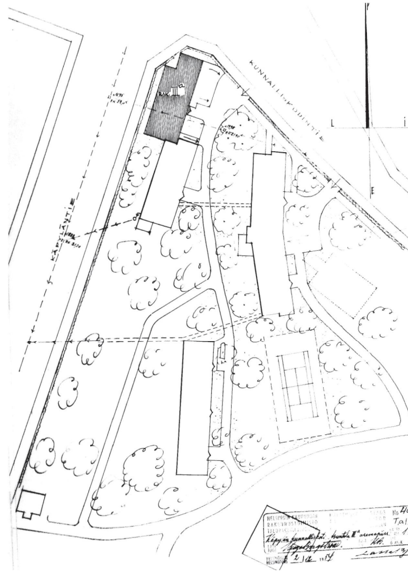
Asemapiirros asuinrakennusten alueelta vuodelta 1954. Suunnitelman on laatinut Hugo Borgström. Edellisestä suunnitelmasta poiketen vanha juuresvarasto on säilytetty ja asuinrakennuksia on kolme kappaletta. Piha-alueet on esitetty kuvissa hyvin luonnosmaisesti. Uutta edellisestä suunnitelmaan verrattuna on piha-alueelle sijoitettu pallopelikenttä. Tätä ei kuitenkaan koskaan toteutettu. (HKR)
