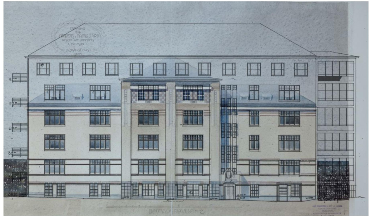
Kuva alla: Lounaisjulkisivun alkuperäinen piirustus projisoituna 1953 laaditun korotuspiirustuksen päälle.
