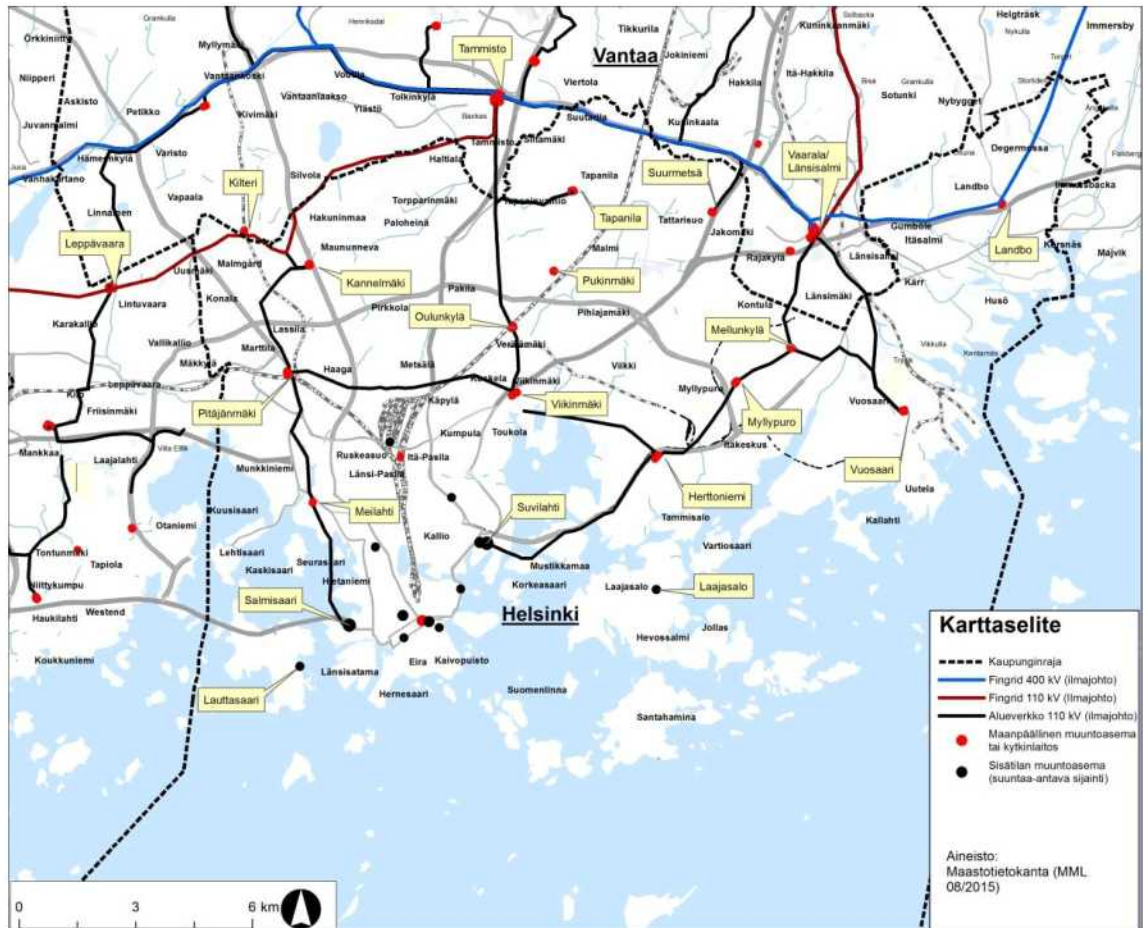
Kuva 5-5. Helsingin alueen suurjännitteinen sähköverkko sekä sen tärkeimmät muuntoasemat.
