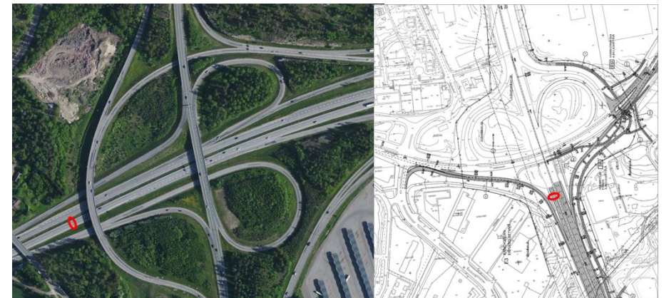
Kapasiteettikapeikat Turunväylän Kehä II:n sekä Hämeenlinnanväylän Kaivokselan liittymissä, kun tiesuunnitelmien mukaiset lisäkaistat on toteutettu.
