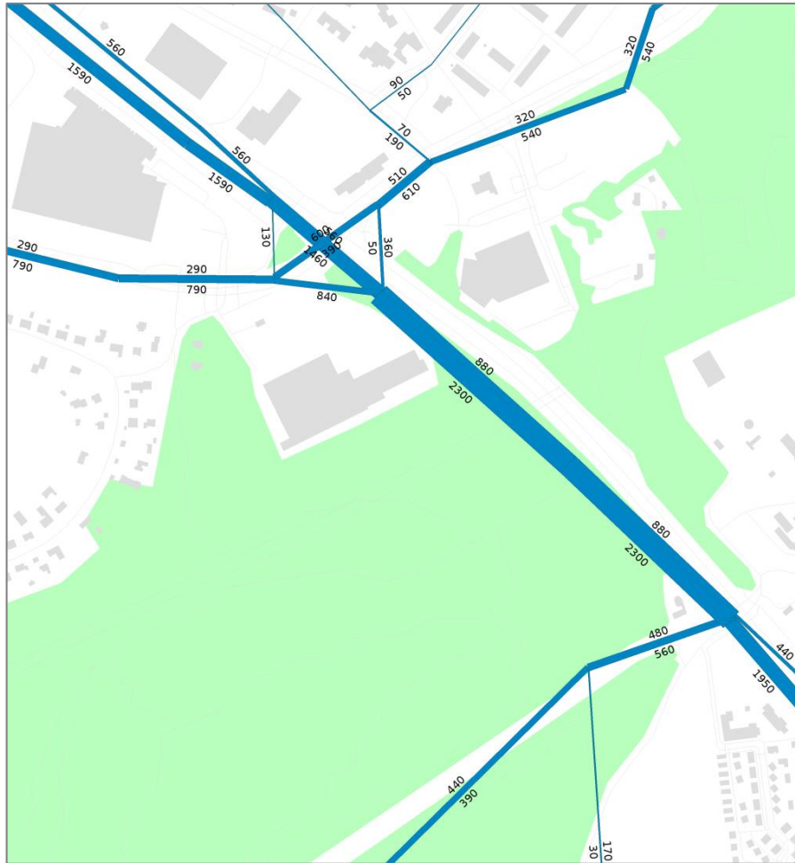
Rajatorpantien eritasoliittymä nykyisellä paikalla ja Lintulaaksontieltä yhteys vain Vihdintielle (V1b) liikennemääräennuste, aamuhuipputunti 2025.
