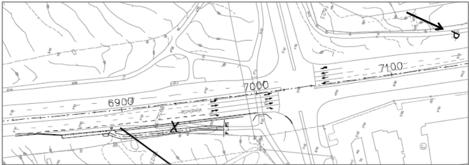
Oikealle kääntyvän kaistan jatkaminen Vihdintien ja Luhtitien liittymässä (lähde sama kuin edellä).
