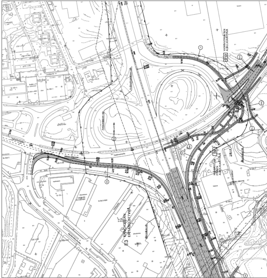
Kaivoksen liittymän parantaminen ja lisäkaistat (Hämeenlinnanväylän tie-suunnitelma 2009).
