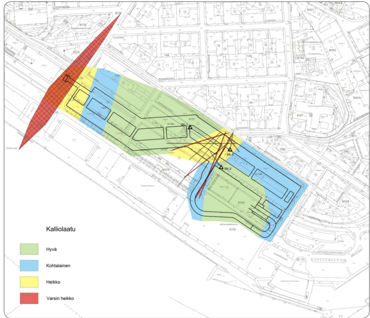
Kuva 2.2. Kallioperätutkimukset ja niiden tulkinta.
