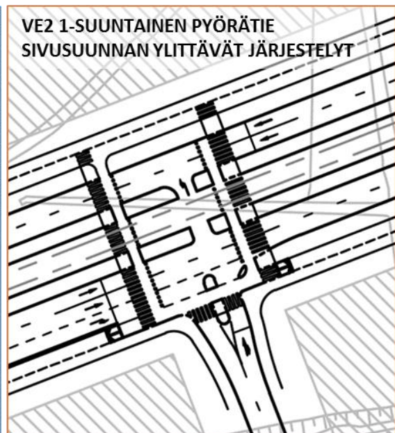
Kuva 22. Pyörätieperiaatteet liittymissä ja pysäkkien kohdalla (vaihtehtoinen ratkaisu VE1:n osalta esitetty Liikenneturvallisuus-luvussa).
