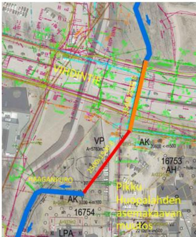
Kuva 2. Haaganpuron Vihdintien alittava nykyinen siltarumpu. Siltarummun koko oranssilla, uudella osuudella 3,5x2,5 m ja punaisella vanhalla osuudella 2,5x1,5 m. Sininen osuus on avouomaa.
