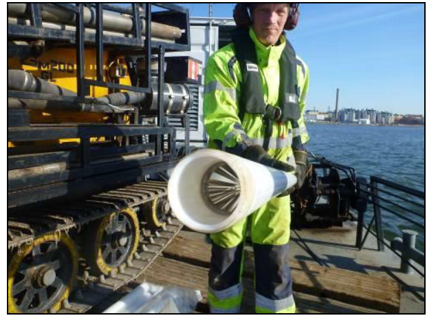
Kuva 7. Näytteenottokalustoa, muoviputki ja liuskesulki-ja.
