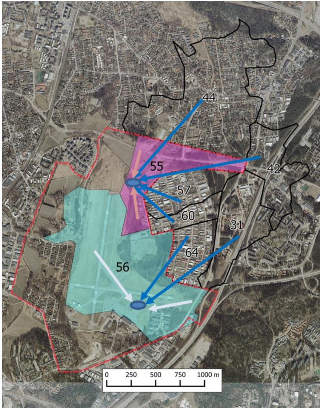
Kuva 20. Havainnekuva puistoalueiden (pohjoinen ja eteläinen) keskitettyihin hulevesirakenteisiin liittyvistä valuma-alueista. Numerot valuma-alueiden päällä kuvaavat läpäisemättömän pinnan määrää (TIA). Värityt valuma-alueet kuvaavat kaava-alueelta hallintajärjestelmään kytkettäviä alueita ja niiden oletettua läpäisemättömän pinnan osuutta rakentamisen jälkeen. Koko kaava-alueen rajaus punaisella katkoviivalla.
