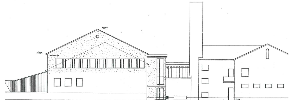
Länsijulkisivu korotuksen jälkeen. Huomaa nauhaikkuna ja uusi porrashuone. Myös länsipäädyssä alkuperäinen kaari-ikkuna ullakolle korvattu pienellä ikkunalla. Pauli Lehtinen 1965. Kuvallähde: Rakennusvalvonnan arkisto.
