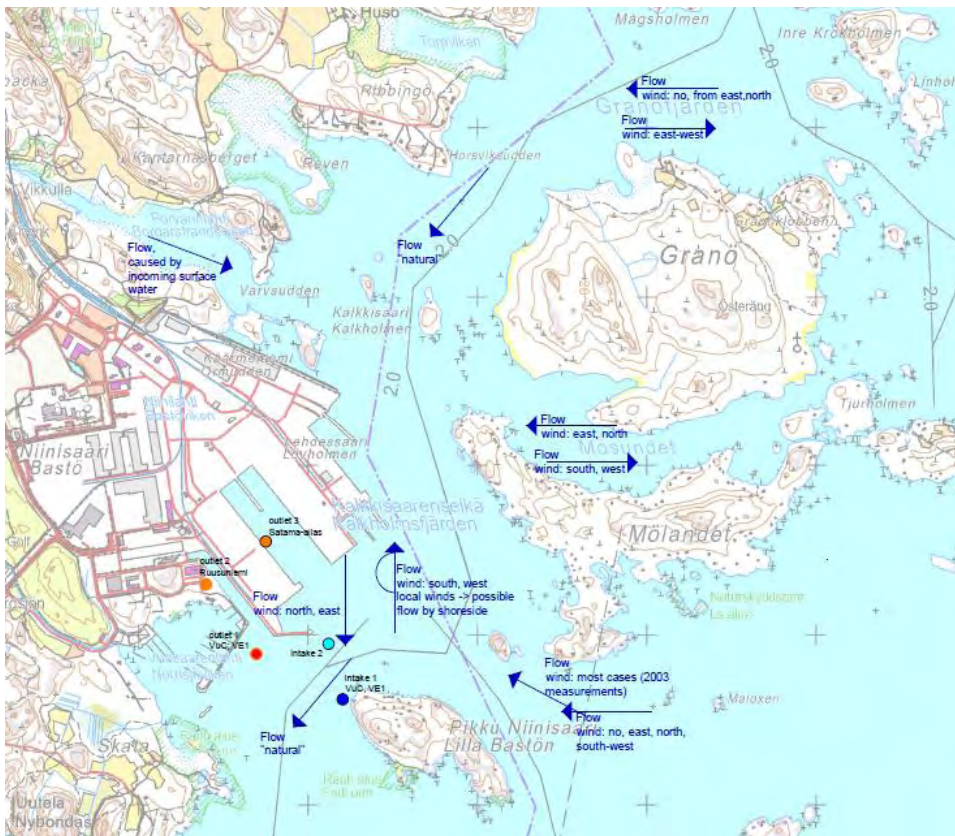
Kuva 3. Havaitut veden virtaukset eri tuuliolosuhteissa.
