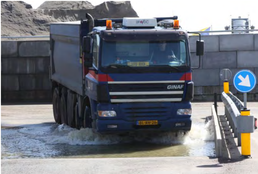
Kuva 6-2 Esimerkki renkaiden pesusta, ajo vesialtaan kautta.
