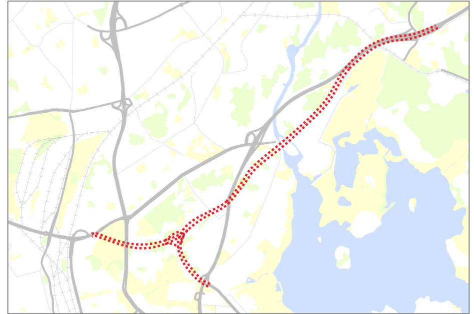
Lahdenväylän tunneli ja sen kytkeytyminen Pasilanväylän tunneliosuuksiin (viitteellinen).
