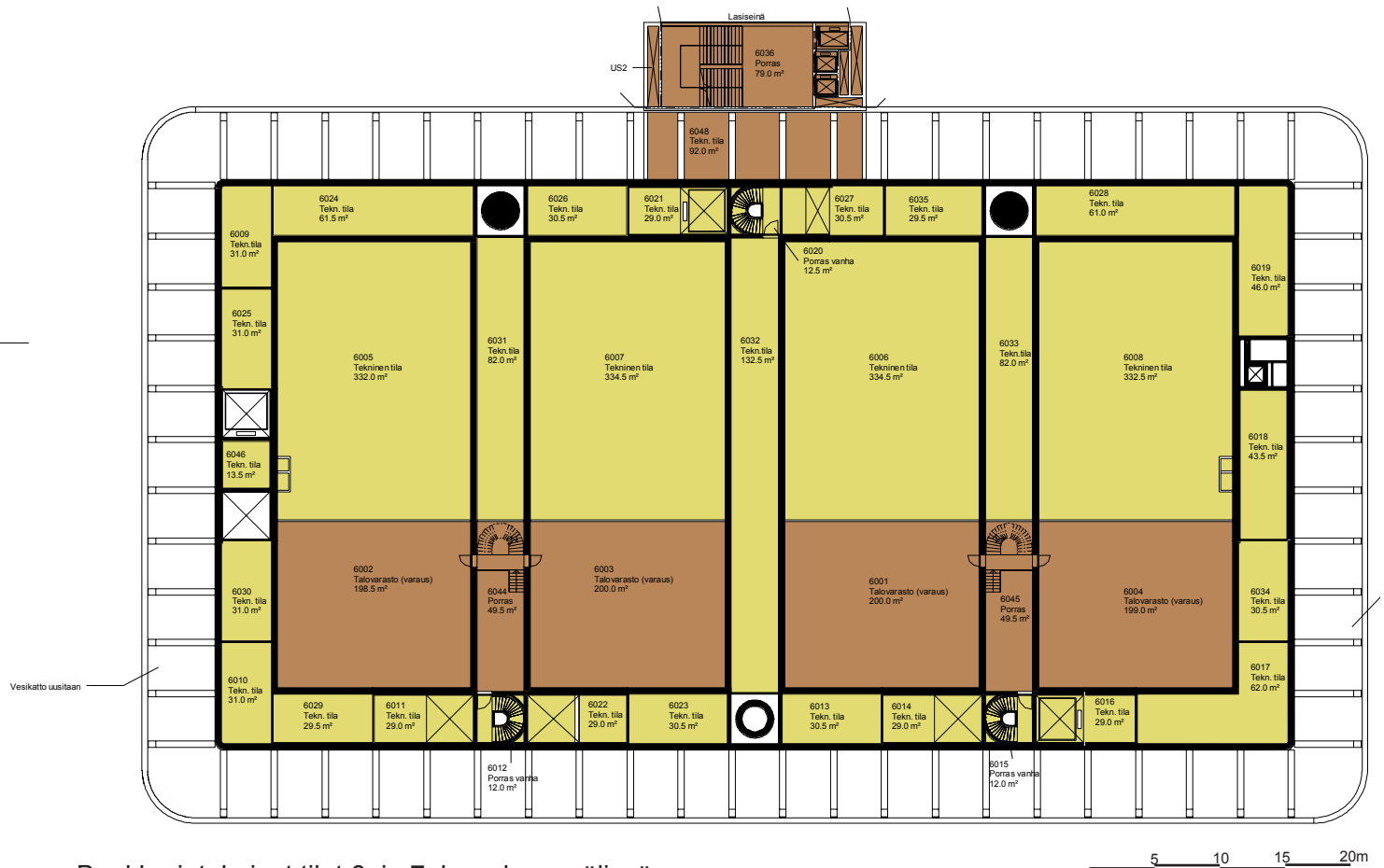
Bunkkeri, tekniset tilat 6. ja 7. kerroksen välissä.
