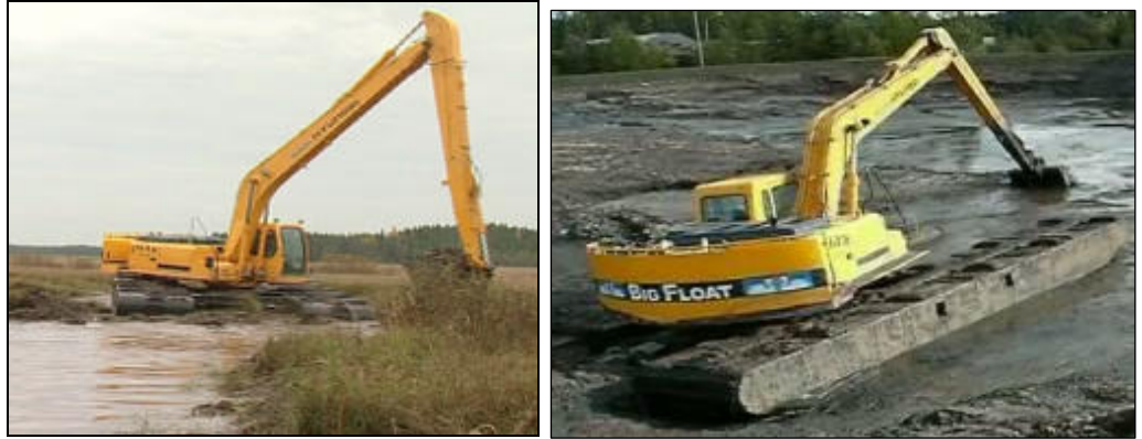
Kuva 55. Esimerkki vaikeakulkuisiin maa- ja vesiolosuhteisiin soveltuvasta kauharuoppaajasta (Big float, esittelyvideo).
