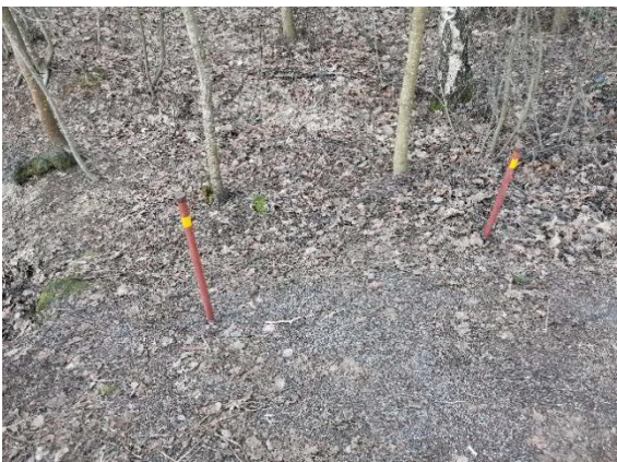
Valokuva 5. Vesinäytteet otettiin pohja- ja orsiveden tarkkailuputkista (kuvassa 12669/10P ja 12669/10O).
