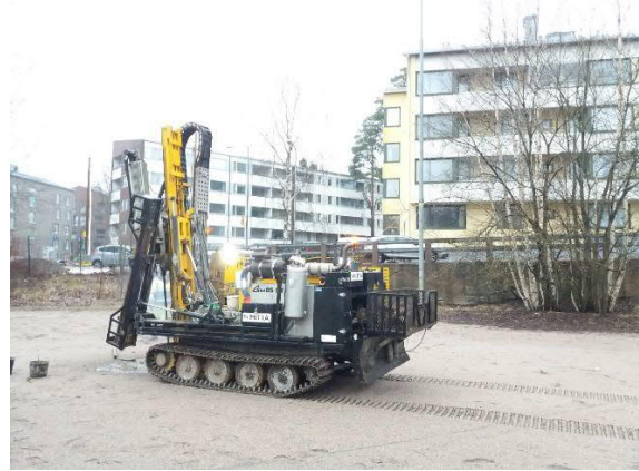
Valokuva 2. Näytteenotossa käytetty porakaira.
