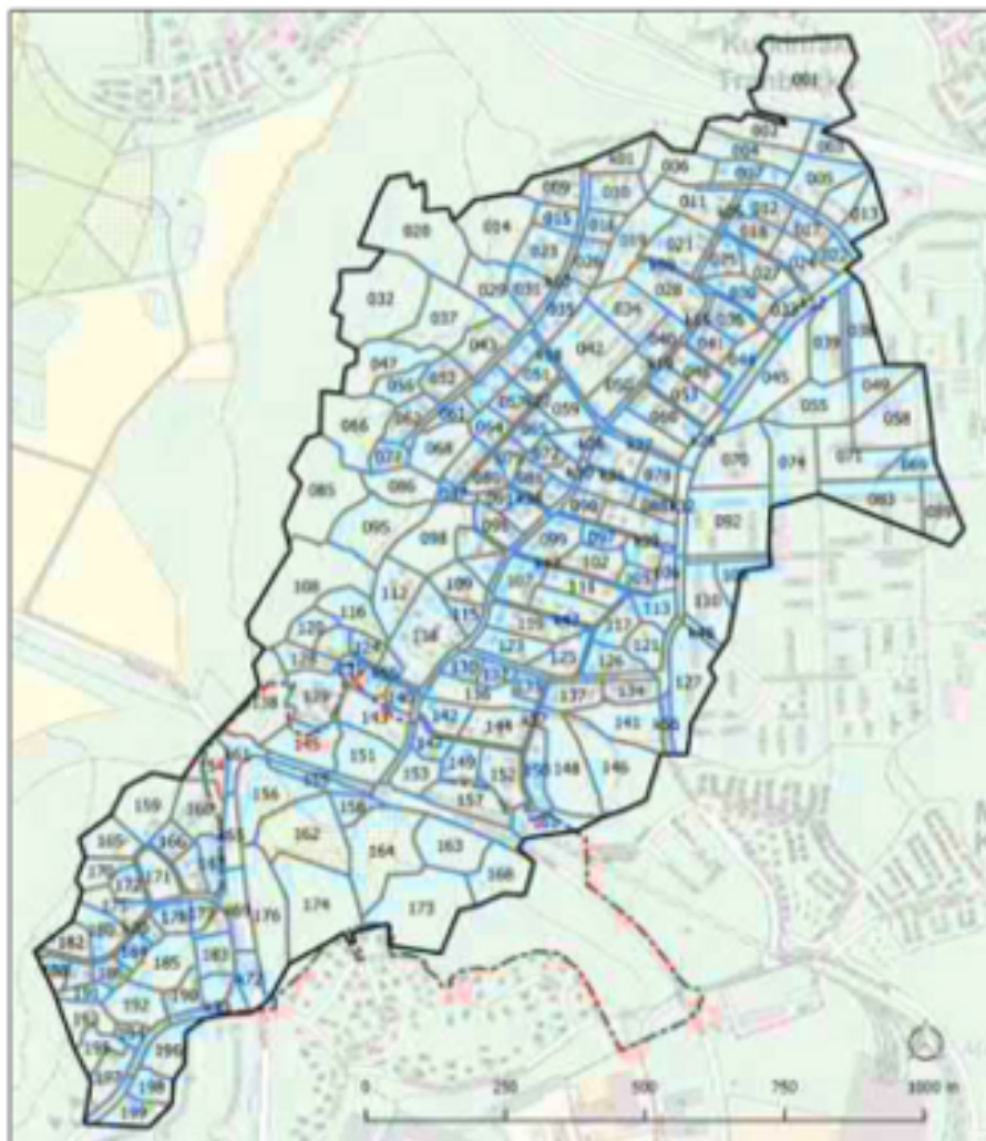
Kuva 16. Selvitysalue jaettiin osavaluma-alueisiin mallinnusta varten.
