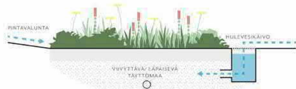
VIIVYTYSRAKENNE PIHOJEN TÄYTTÖKERROKSISSA
