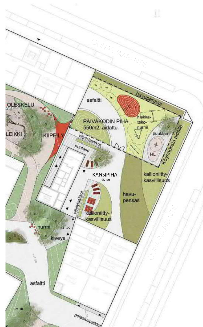
Vaihtoehtona sijoittaa pysäköintihallin kattopihalle päiväkodin piha 1:500
