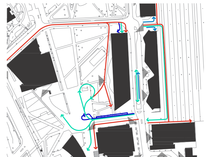
Ratapihan läntisen puolen pelastus-, huolto- ja saattoajon reittejä. Merkittynä myös ajoreitit rakenteellisiin pysäköinteihin.
