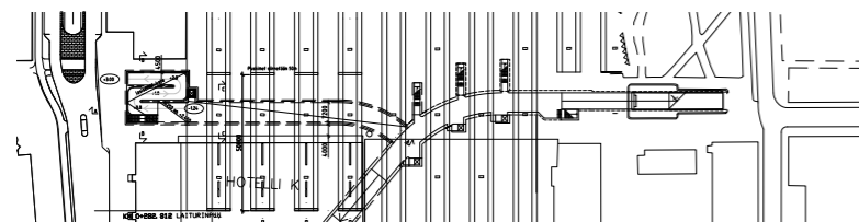
Siksak-ramppirakenne. Uusi alikäytävä liittyisi olemassa olevan alikäytävän kylkeen.
