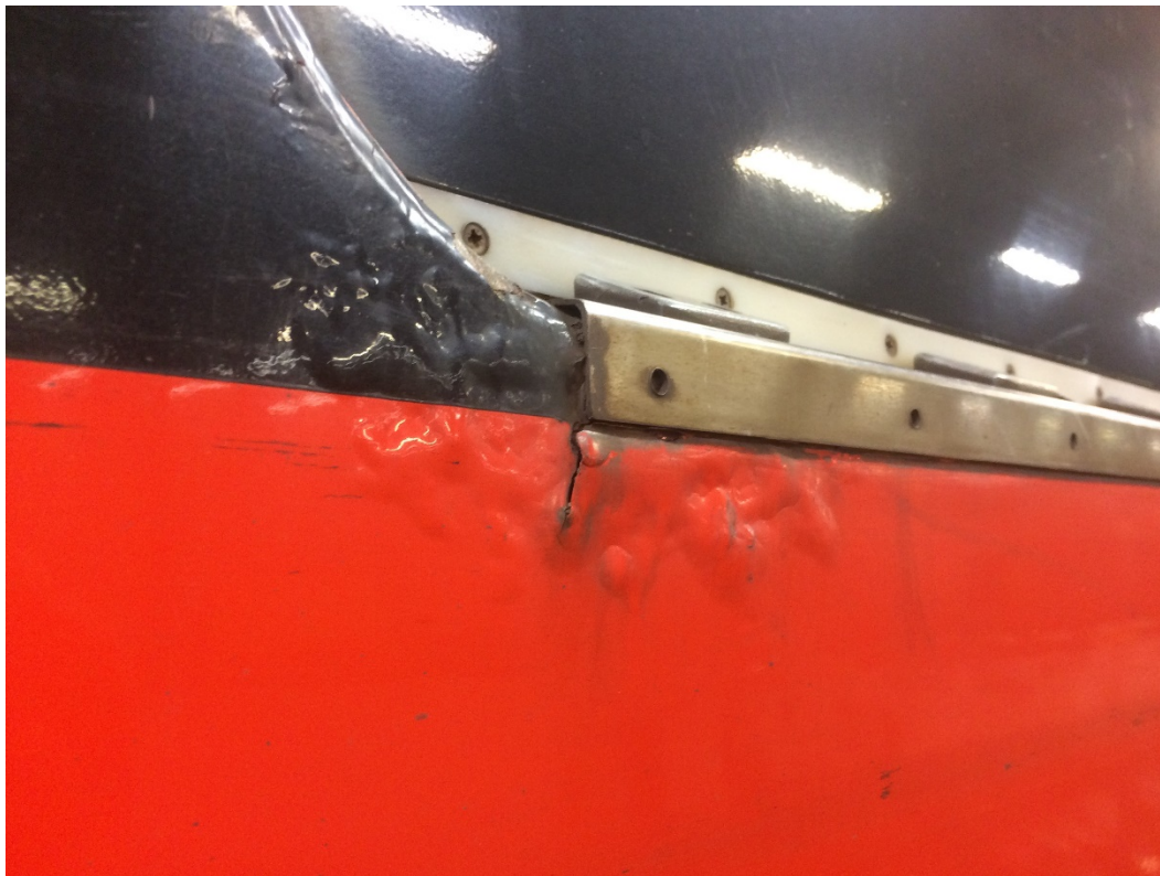
Kuva 4. M100-junan korin korroosioaurio oviaukossa.
