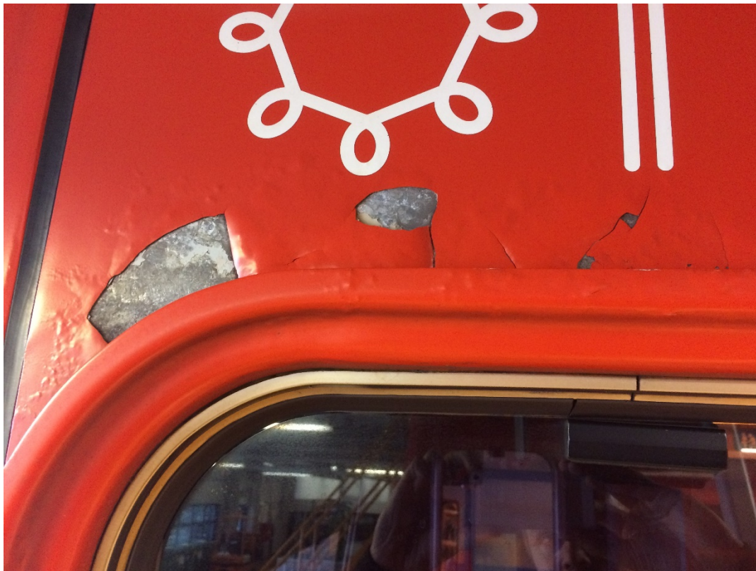
Kuva 1. M100-junan paikallisesti irronnut maalikerros ohjaamon sivuikkunan yläpuolella.
