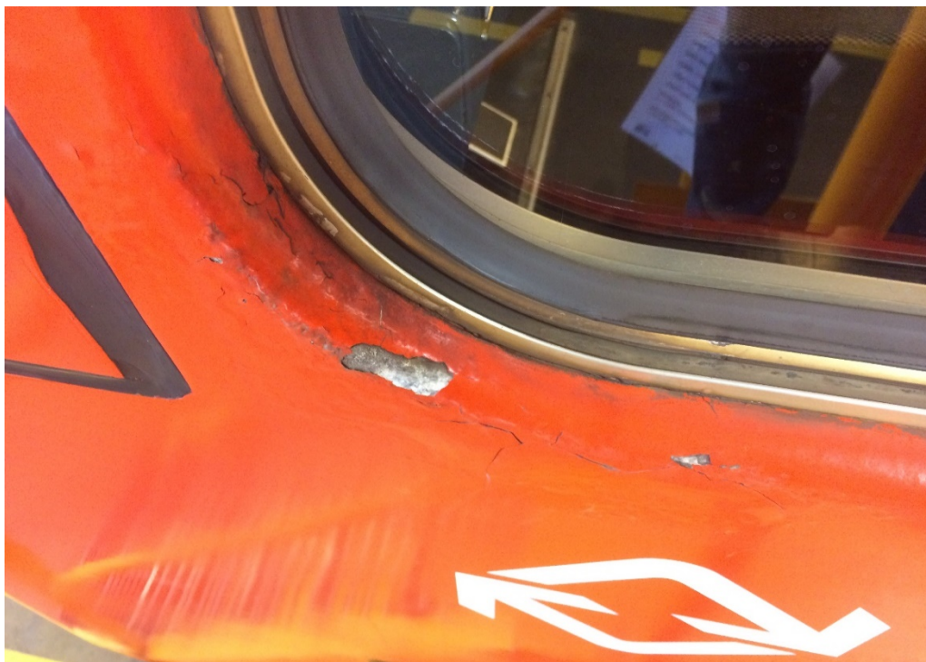
Kuva 2. M100-junan maalipinnan sisäsyntyinen vaurio ohjaamon ikkuna-aukon ympärillä (sivuikkuna).
