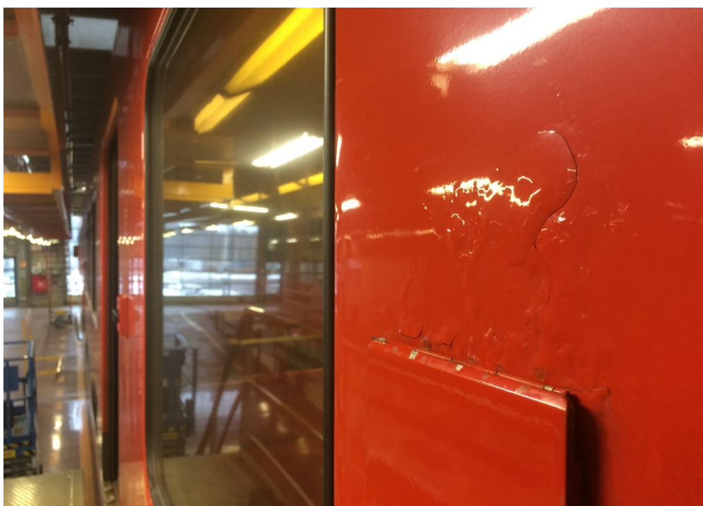
Kuva 3. M100-junan maalipinnan vaurio kyljen painonappikotelon yläpuolella.
