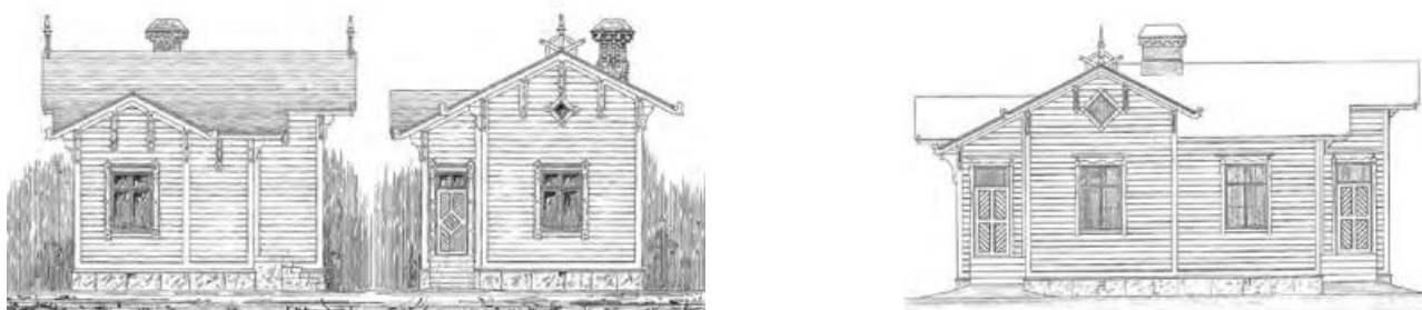
Vasemmalla yksinkertaisen vahtituvan tyyppiinrustus vuodelta 1896 ja oikealla kaksinkertaisen vahtituvan tyyppiinrustus vuodelta 1901. Kuvat: Museovirasto, Rautatierakennusten korjausohjeet.
