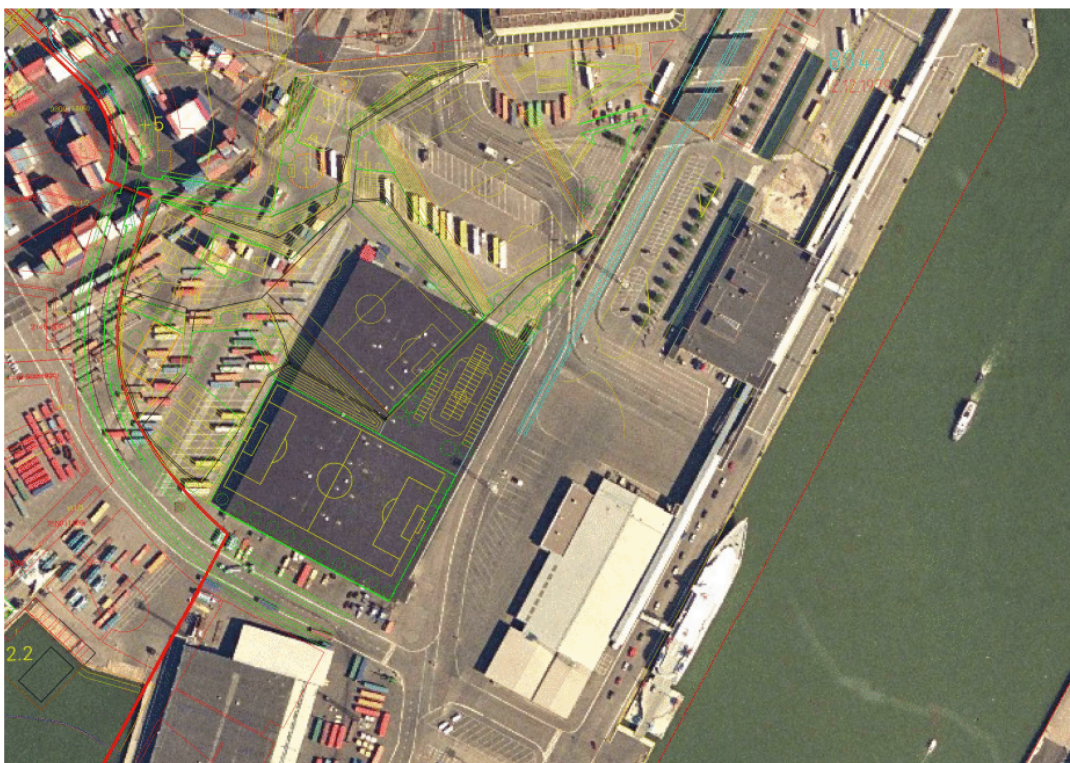
Kuva 4. Maanvarainen varastohalli (keskimääräinen kuormitus ~50 kPa) on sijainnut suunnittelualueella vuosina 1974...2009 ja toiminut siten esikuormituksena 35 vuotta.
